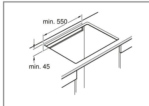
3. Hvis minimumafstanden på bagsiden af skabet på 20 mm ikke kan overholdes, skal der etableres en åbning på undersiden.
